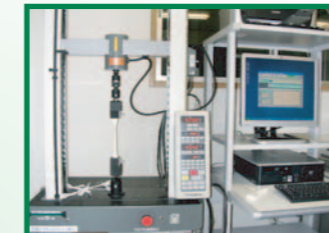
⑦ダンベル引張り試験
